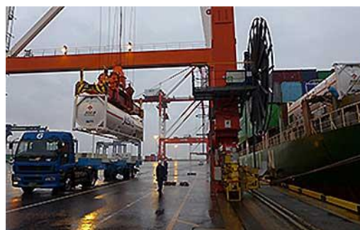
ひびき灘での中国向け ISO コンテナ積み込み作業
